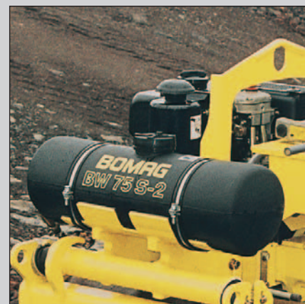
Два объемных водных бака, выполненные из антикоррозийного материала, подходят для работы на асфальте
